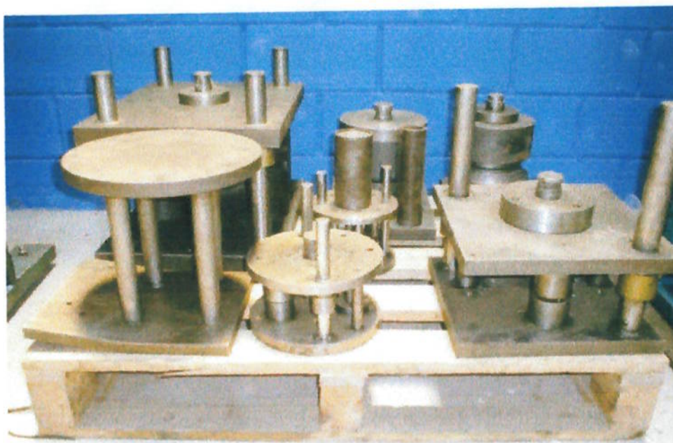
Figura 4.11 - Matrizes da prensa das escovas circulares
