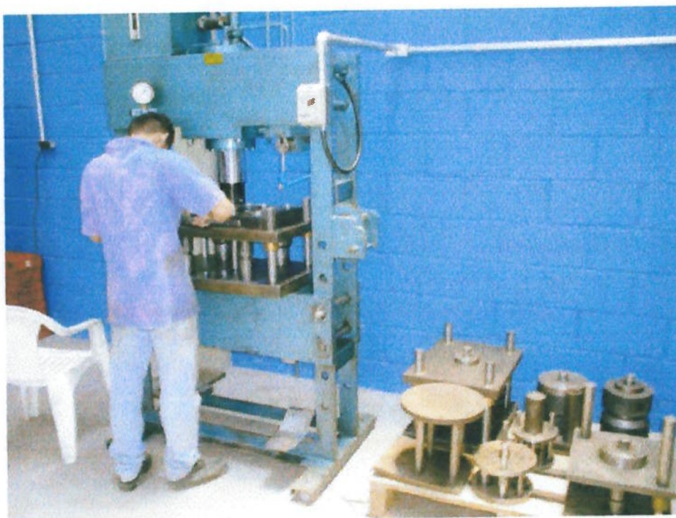
Figura 4.10 - Operador na prensa das escovas circulares
