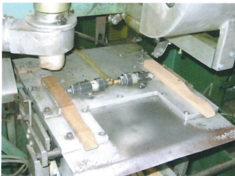
Figura 2.7 - Fabricação da escova com cabo
